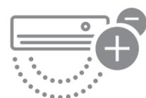
ВСТРОЕННЫЙ ГЕНЕРАТОР ХОЛОДНОЙ ПЛАЗМЫ ВЫРАБАТЫВАЕТ АКТИВНЫЕ ИОНЫ ВОДОРОДА И КИСЛОРОДА, КОТОРЫЕ СОЕДИНЯЮТСЯ В ВОЗДУХЕ С ВРЕДНЫМИ ВЕЩЕСТВАМИ, БАКТЕРИЯМИ И ВИРУСАМИ. СВЯЗАННЫЕ ВМЕСТЕ, ОНИ ОСЕДАЮТ НА ПОВЕРХНОСТИ И С КОНДЕНСАТОМ УДАЛЯЮТСЯ ИЗ КОНДИЦИОНЕРА.
