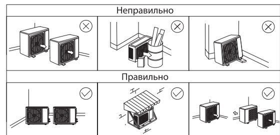
Рисунок 31 - Требования к месту установки внешнего блока
