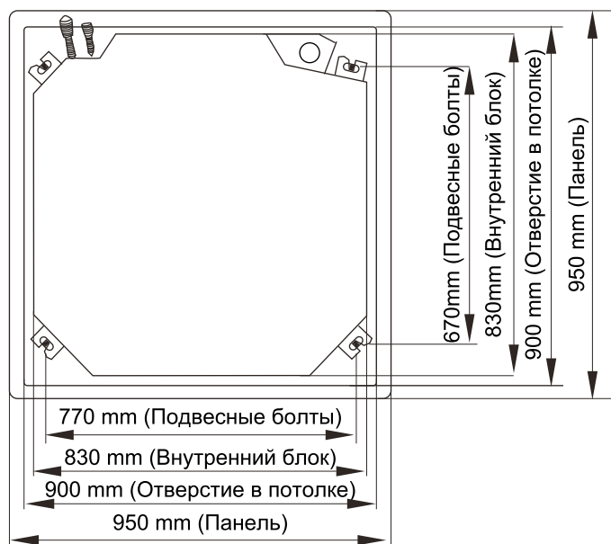
Рисунок 14 - Монтажные размеры внутренних блоков кассетного типа
